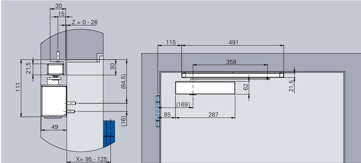
Normalmontage ECO TS-61 G (EN 3 – 6) mit Gleitschiene HF, Bandgegenseite (Sturzfutterwinkel), DIN-R
