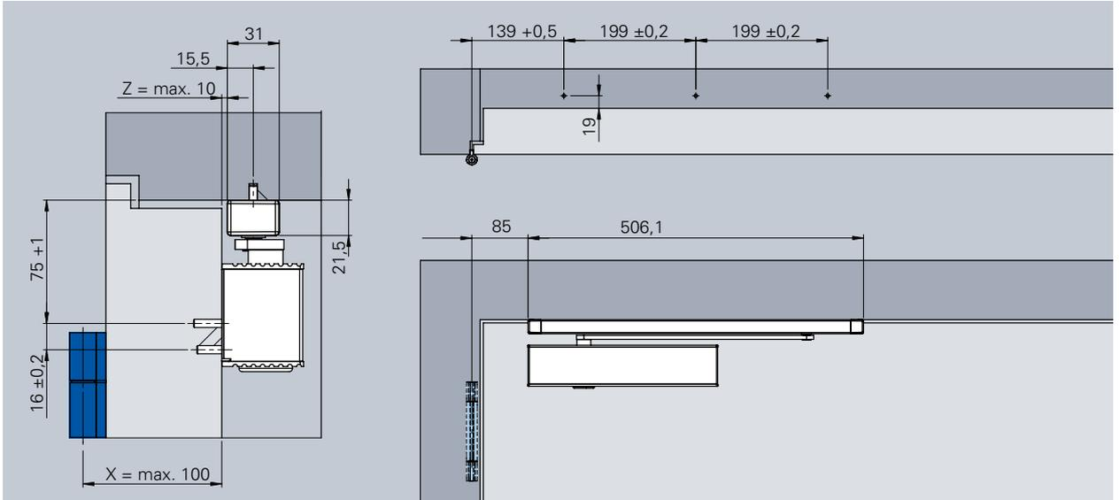
Normalmontage ECO TS-61 G (EN 3 – 6) mit Gleitschiene STM, Bandgegenseite (Direktmontage), DIN-R
